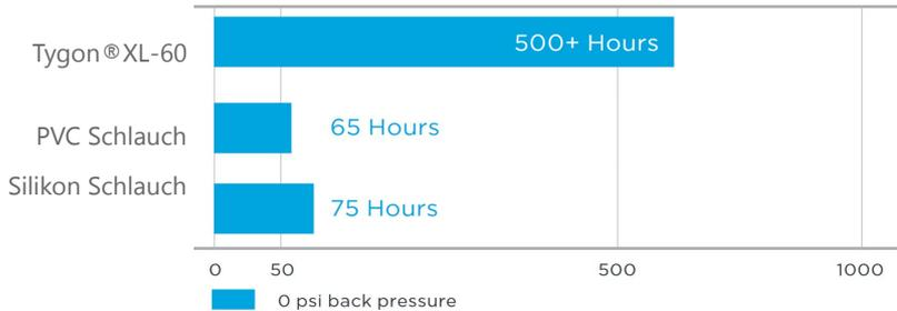
Die Leistung von Schläuchen bei peristaltischen Pumpenanwendungen wird von den Einsatzbedingungen und der verwendeten Ausrüstung sowie von der Größe und Wandstärke der getesteten Schläuche beeinflusst. Die oben genannten Daten dienen nur zu Informationszwecken und sollten nicht für Spezifikationen verwendet werden.
